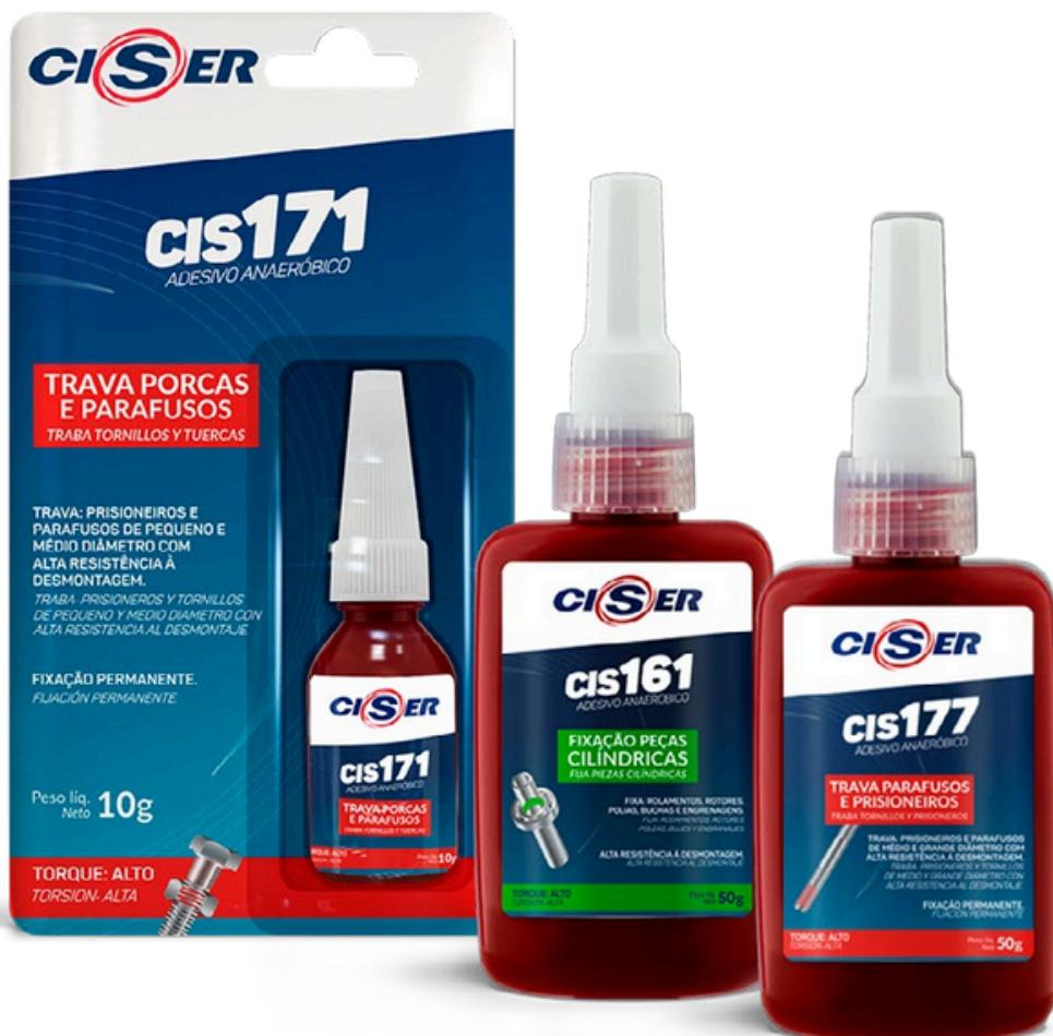
A linha de adesivos anaeróbicos Ciser possui como principal característica a cura na ausência do ar e em contato com metais. Após aplicado cria-se resistência ao afrouxamento, choque, vibrações e corrosão, com excelente capacidade de resistência aos químicos e aos solventes.
