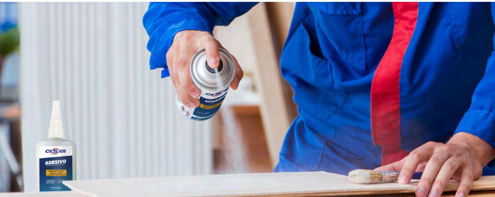
Adhesivo a base de cianoacrilato es un producto monocomponente y no requiere mezcla, su proceso de curado comienza cuando una fina capa del producto es aplicada entre las superficies y entra en contacto con la humedad del aire. El acelerador es un producto monocomponente a base de solvente destinado a acelerar el curado de adhesivos a base de cianoacrilato, garantiza mayor adherencia y pegado instantáneo.
