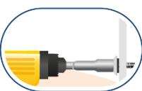
**2.** Faça a regulagem do limitador de profundidade, antes de aplicar na telha.
