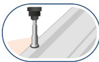
**3.** Realize a aplicação na telha. Sempre que possível efetuar a fixação na onda alta.
