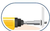
**2.** Faça a regulagem do limitador de profundidade, antes de aplicar na telha.
