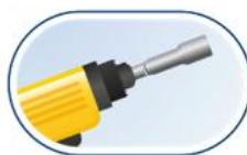
1. Escolha a parafusadeira correta para instalação. A CISER recomenda parafusadeira com rotação de 1800 a 2500 RPM e com limitador de profundidade.
