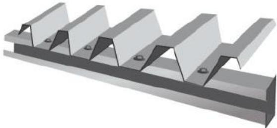
Utilizados para realizar a fixação de telhas singela em terça ou chapa metálica. Se a fixação for na onda baixa, o parafuso deve ser aplicado na linha d'água (nunca no mini trapézio), utilizando no mínimo quatro fixadores por telha.
