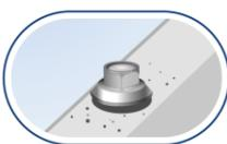
4. Faça a limpeza removendo os cavacos e limalhas.
