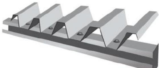
Utilizados para realizar a fixação de telhas singela em terça ou chapa metálica. Se a fixação for na onda baixa, o parafuso deve ser aplicado na linha d'água (nunca no mini trapézio), utilizando no mínimo quatro fixadores por telha.
