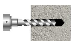
Perfure o concreto com uma broca de diâmetro igual ao diâmetro externo do chumbador.
