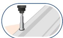
3. Realize a aplicação na telha. Sempre que possível efetuar a fixação na onda alta.
