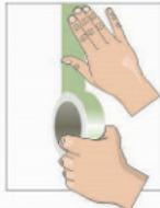
Aplicar a fita sobre a junta pressionando-a firmemente.
