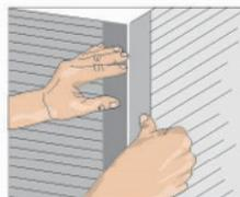
Dobre a fita ao meio e aplique com a face metálica voltada para a massa.
